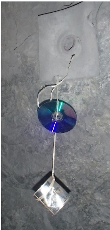
Фигура 6. Позициониране на дифузионна камера и CD/DVD диск в минна галерия.
